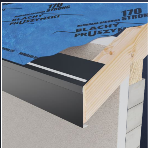
Montaż membrany dachowej na krokwiach Przyklejenie membrany do pasa podrynnego
