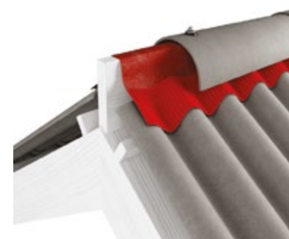
7 pav. Kraigas uždengtas pusapvaliu kraigu ir kraigo juosta – ventiliavimo paviršius 1 bėginiame metre kraigo: lakštai B59/W130-9 – 150 cm 2 , lakštai B65/W177-6,5 – 255 cm 2 kiekvienam šlaitui.
